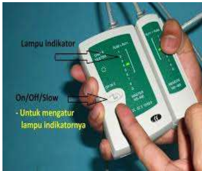
Gambar 1: Pengujian kabel LAN dengan Cable Tester
